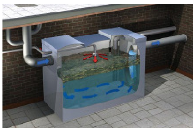
Figur 1. Eksempel på en gulvstående fettutskiller i kjeller. Illustrasjon: ODIN Maskin AS.
