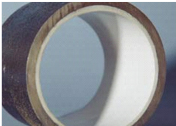
Figur 9: Under og etter påføring av belegg.
