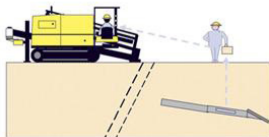
Figur 5. Walkover posisjoneringssystem [SSTT].
