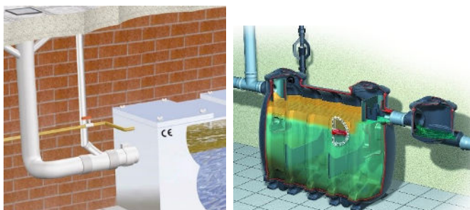
Figur 3. Lufting av fettutskiller.
