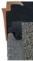
Figur 4: Ø 650 mm kumramme flytende i 100 mm asfalt. Her er det brukt 50 mm dempering i hardplast
